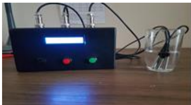
Figura 2. Captação dos dados de temperatura pelos sensores DS18B20.
