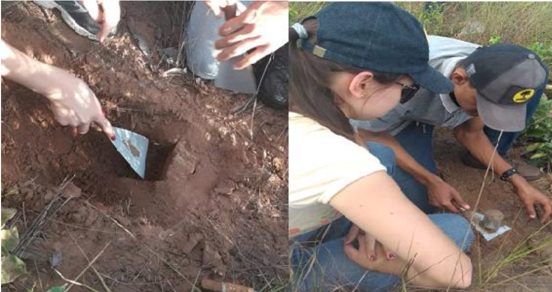
Figura 1: Coleta das amostras de densidade do solo utilizando o método MAV.
